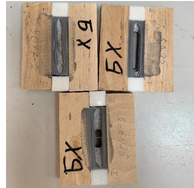
Рисунок 8 – Адгезионные / когезионные свойства при переменной температуре и растяжении-сжатии с амплитудой \pm 25\%
