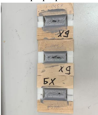
Рисунок 5 - Внешний вид образцов после определения адгезионных / когезионных свойств после выдерживания в растянутом состоянии на 100 %
