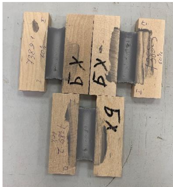
Рисунок 7 - Внешний вид образцов после определения адгезионных / когезионных свойств после выдерживания в растянутом состоянии на 60 %
