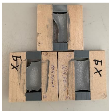
Рисунок 6 – Внешний вид образцов после определения адгезионных / когезионных свойств после выдерживания в воде и растяжения на 100 %
